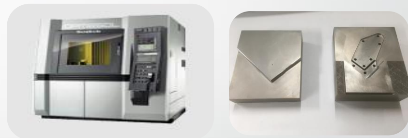
【金属 3 Dプリンターと作成した入れ子 O P Mラボラトリー様御協力】
